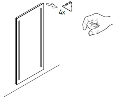
Entfernen Sie alle Spiegelschutzecken.
