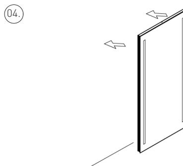
Hängen Sie den Spiegel an die Wand. Bitte beachten Sie, dass der Spiegel nur in die ausgestanzten Löcher eingehängt werden kann.
