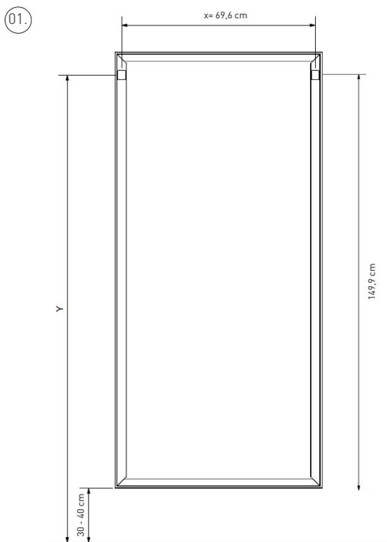
Übertragen Sie die Position der Aufhängung vom Spiegel auf die Wand (x & y) und bohren die 8 mm Löcher für die beiliegenden Dübel.
