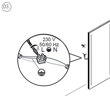
Falls der Spiegel nicht über eine Steckdose angeschlossen wird, bitte folgende Schritte beachten: Durchtrennen Sie das Kabel auf der Spiegelrückseite auf die passende Länge und ziehen das restliche Kabel mit Schuko-Stecker durch die Lochbohrung im Rahmen. Schließen Sie nun den Spiegel an den Strom an.
