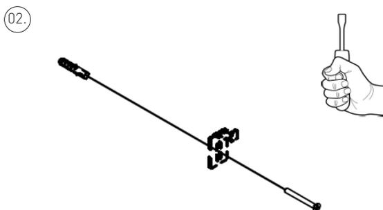
Bringen Sie die Aufhängehaken in die Dübel an und richten Sie diese mit einer Wasserwaage aus.
